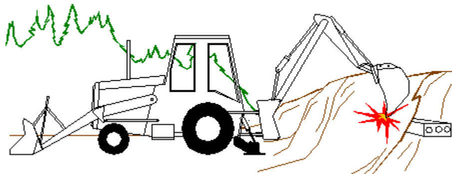
Figura 1 – Contatto con linee elettriche interrato
